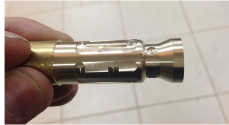
Cilindro de latón torneado y fresado
