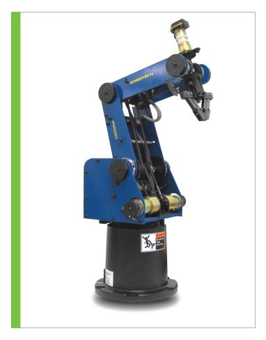
El robot ScorBot ER-4U es un sistema de brazo robótico de 5 ejes versátil y fiable para uso educativo. El brazo robótico ScorBot ER-4U puede ser montado sobre una mesa, un pedestal o una base de deslizamiento lineal.
